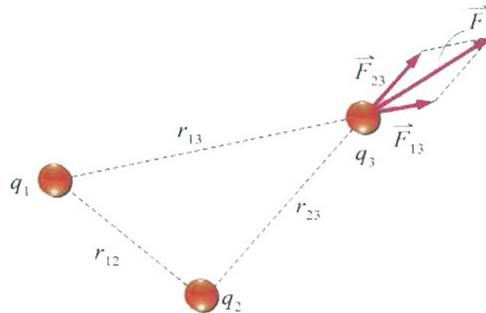
圖 1. 三個正電荷  $q_1$ 、 $q_2$  與  $q_3$ ，彼此相距為  $r_{12}$ 、 $r_{13}$  與  $r_{23}$ ， $q_1$  與  $q_2$  作用在  $q_3$  之總靜電力為  $\vec{F} = \vec{F}_{13} + \vec{F}_{23}$ 。此力將  $q_3$  自原處移動至無限遠處所作的功，等於  $\vec{F}_{13}$  將  $q_3$  自  $r_{13}$ ，與  $\vec{F}_{23}$  將  $q_3$  自  $r_{23}$  處，移動至無限遠處所作功之和。
